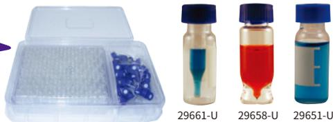
低吸着性バイアルは、pH の変化や表面活性を最小とし計量値を良好とします。これは、これまでの化学的的表面処理 (シラン処理) ではなく、ガラス表面の硫酸基を減少させる工程を用いているためです。この工程によりナトリウムやホウ素など不要な表面金属も排除されます。
