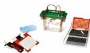
Protein Electrophoresis / Western Blotting | セミドライ式ブロットティング機器、転写パック、フィルターペーパー
