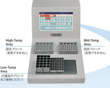
High-Temp AreaとMid-Temp Areaに装着されているブロックは0.2 ml チューブ用(32ウェル) と1.5/2.0 mlチューブ用(5ウェル) になります。
